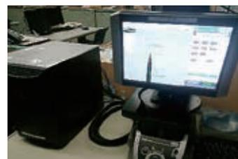
画像寸法測定器での製品検査
