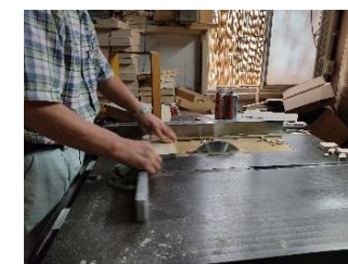
改善前 (刃が露出、ベテランの操作が必要)
