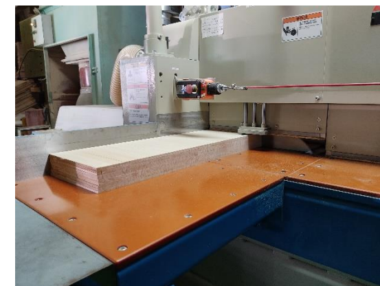
木取り(カット)工程の作業性・安全性が大幅に向上
