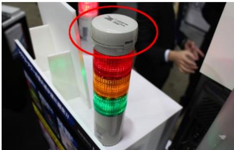
既存設備のパトライトに装着するだけで、設備の稼働状態を把握。特別な配線等 unnecessary、既存設備を応用したIoT。
