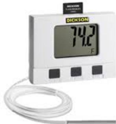
温度の変化に伴って抵抗値や熱起電力が変化する特性を利用し温度を測定する。
