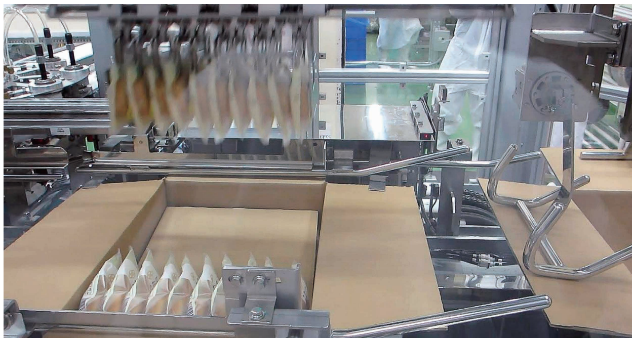
ロボットケーサーが製品を掴んで箱に運ぶ
