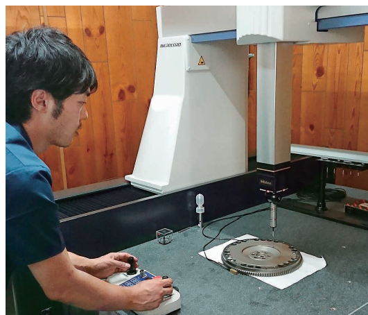
自動車部品の歯車 熱処理後完成品の検査
