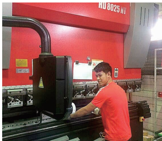
プレスブレーキによる深曲げ加工
