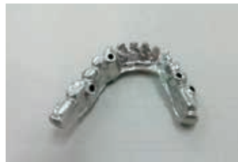
難削材を加工した「歯型インプラント」
