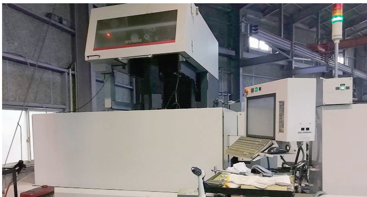
三菱電機(株)製ワイヤー放電加工機 MV-4800 仕様:0.3mmD.D
