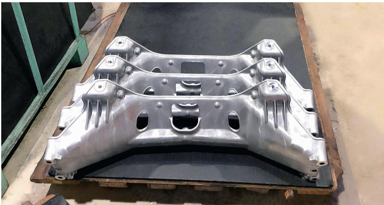
軽量化部品 アルミ製リヤサブフレーム
