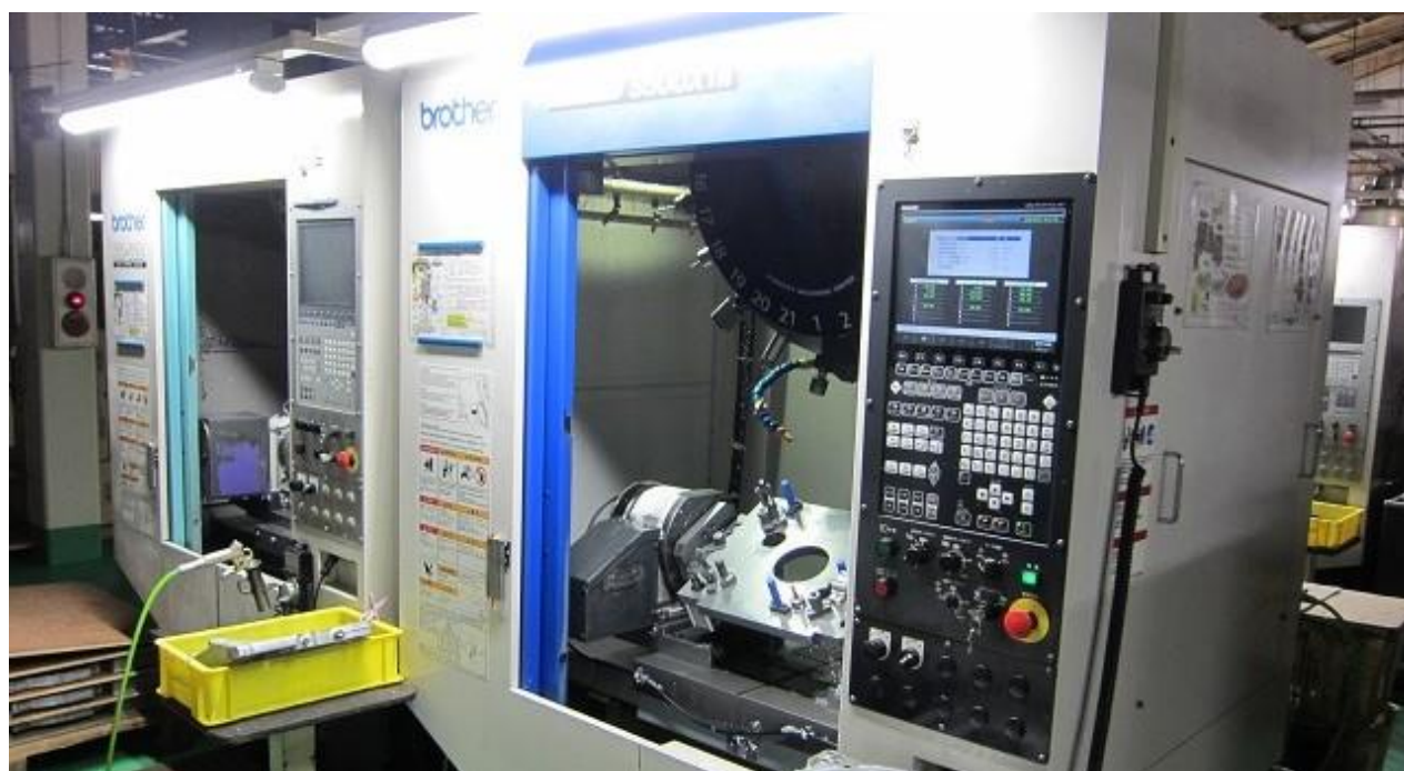
円テーブルの付帯による4面加工
